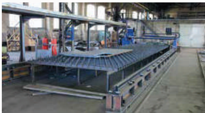
Die neue CNC-Brennmaschine kann schnell mit den im Büro erstellten Schnittanweisungen programmiert werden
