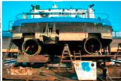
Neue promarin Düsen für das Schubboot DOMARIN 15
